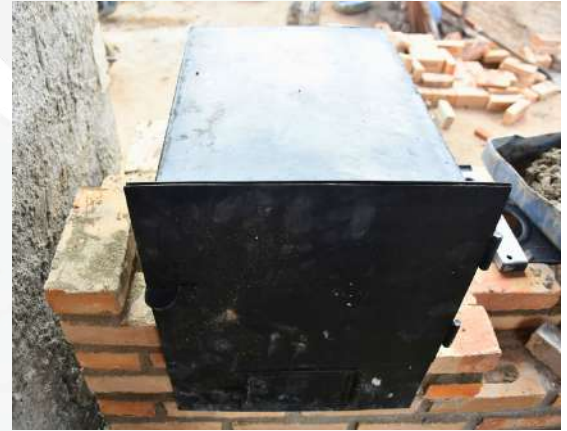
Figura 22 - Detalhe do forno em ferro fundido com cinzeiro
