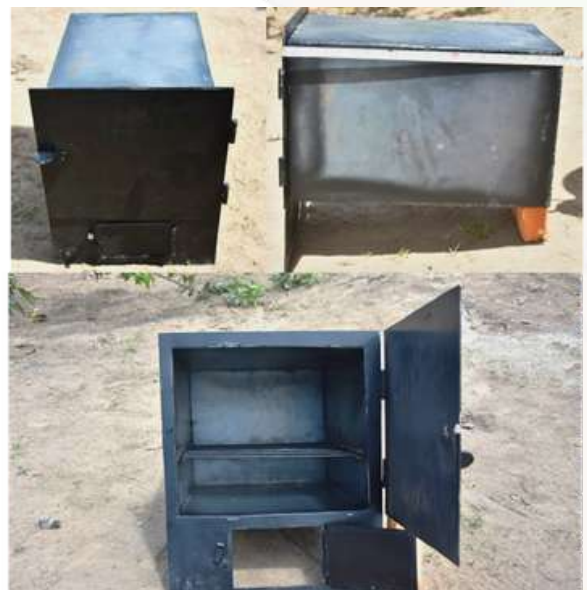
Figura 21 - Detalhe do forno em ferro fundido com cinzeiro
